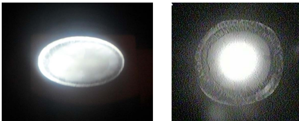
Рисунок 3 – Электронное изображение на люминофоре области эмиссии с катода. Слева – прямонакальный катод без водяного охлаждения, справа – катод с лазерным подогревом и с водяным охлаждением катодного узла.
