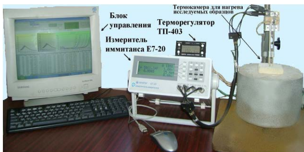
Рисунок 2 – Автоматический измерительный стенд электрофизических параметров сегнето-пъезоматериалов, позволяющий проводить измерения в диапазоне частот от 25 Гц до 10^6 Гц [2]
