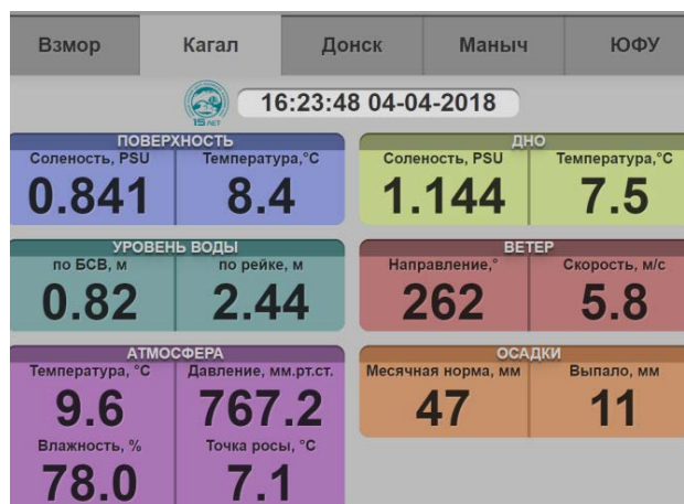
Рисунок 8 – Разработанная в ЮНЦ РАН программная оболочка для отображения в табличной форме данных гидрологического поста поступающих на сервер в реальном времени.
