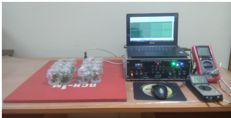
Рисунок 2 – Проведение опыта по магнитотерапии подвоев груши in vitro от вирусов аппаратом АМИС-8 с использованием индуктора ПСИ-1
