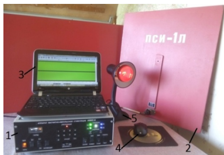
Рисунок 1 – Общий вид комплекта стимулятора АМИС-8: 1 – блок электронный; 2 – индуктор ПСИ-1; 3 – ноутбук; 4 – мышь; 5 – излучатель света
