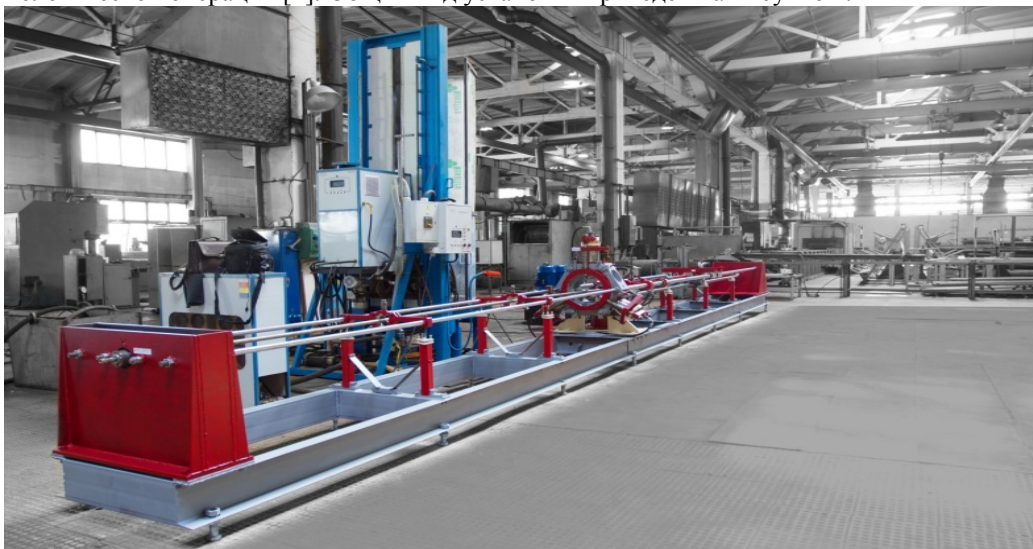
Рисунок 1 – Общий вид установки ВТМО
