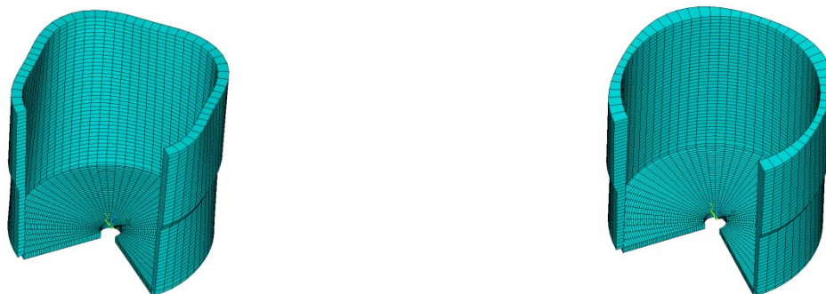
а) Конечно-элементная модель резонатора с дефектом радиуса внутренней поверхности б) Конечно-элементная модель резонатора с дефектом толщины Рисунок 4 – Конечно-элементная модель резонатора
