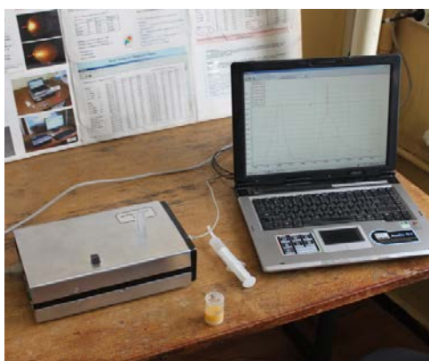
Рисунок 1 – Портативный БИК спектрометр - слева и Протокол определения 7-ми ЖК в среде с его помощью – справа: звездами обозначены доли ЖК, зеленым – поле возможных значений ЖК в пальмовом масле, сиреневым – в молочном жире.
