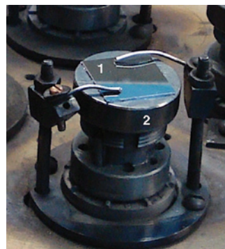
Рис. 2. Изображение образца (1) и нагревательного элемента (2) высокотемпературного приёмника ионов ускорителя ИЛУ-3.
