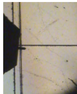
Рис. 1. Оптическое изображение участка стеклянной подложки с нанесёнными метками-микроцарапинами: две вертикальные метки и одна горизонтальная. Слева в центре тень от кремниевого чипа с балкой и АСМ-зондом на конце балки. Ширина балки 35 мкм. Изображение получено на просвет, вид снизу вверх, подсветка сверху.
