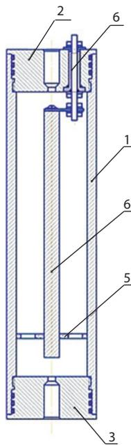
Рис. 2. Чертеж измерительной ячейки.
