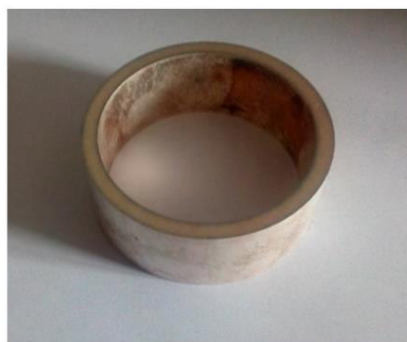
Рис. 1. Кольцевой ультразвуковой преобразователь, изготовленный из керамики ЦТС - 19.
